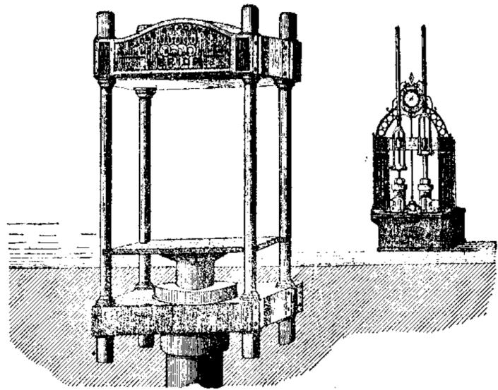
Prensas hidráulicas con cilindros de acero probados a gran presión.
